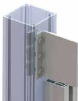
Fig. 24. Mise en place de la cornière au poteau
