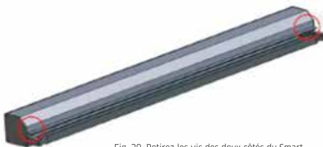
Fig. 29. Retirez les vis des deux côtés du Smart
