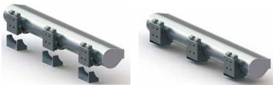
Fig. 7. Mise en place des couvercles sur les platines de montages
