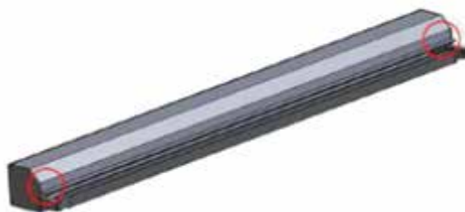
Tek. 29 Draai de bouten van beide kanten loos.
