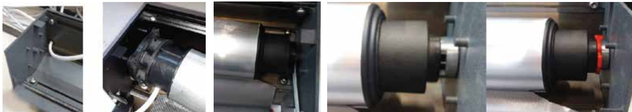
Afb. 3 Montage van een buis in de kast
